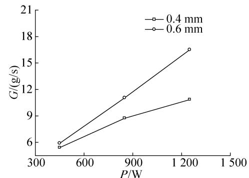
图6 均流器下不同网孔孔径的气泡泵提升速率
