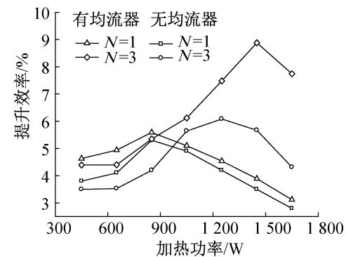
图7 各功率下不同提升管数量的提升效率对比
