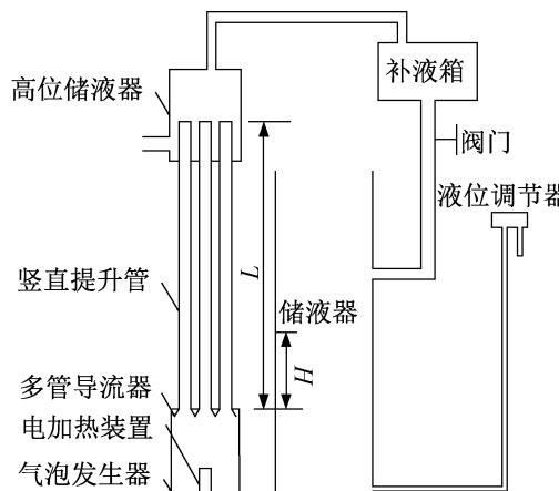
图 1 多管导流型气泡泵结构
