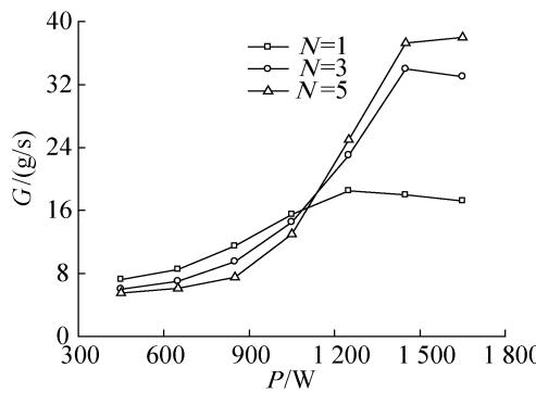
图3 不同提升管数量各功率下的气泡泵提升速率
