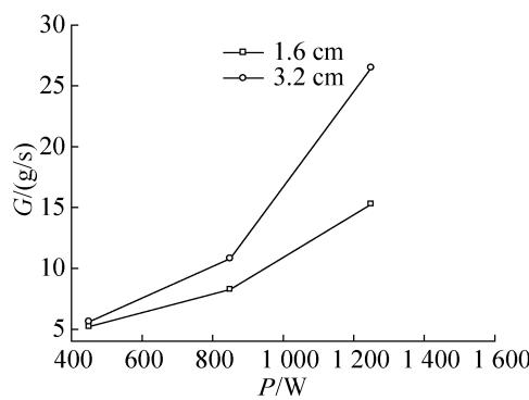
图5 均流器下不同安装高度的气泡泵提升速率
