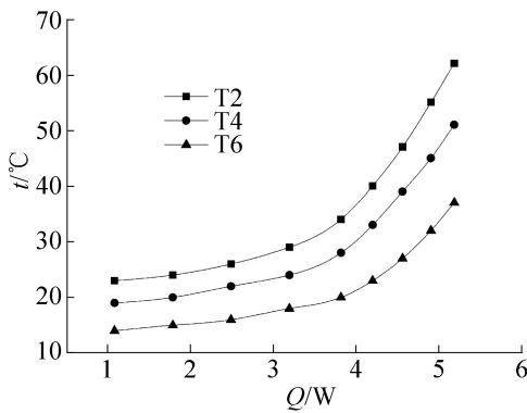
图3 流体温度稳定值随加热功率的变化
