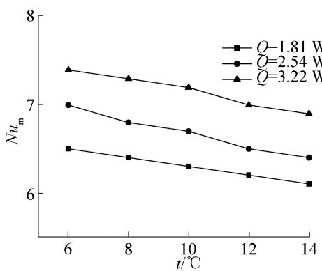
图7 平均努塞尔数随冷却温度变化
