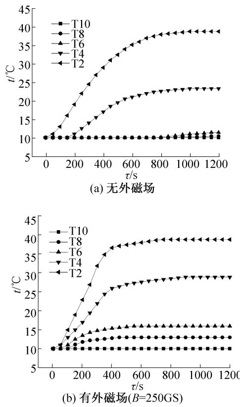
图2 有无外磁场流体的各点温度变化
