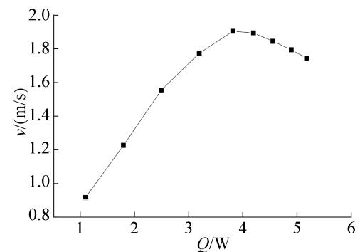
图4 流体流速随加热功率的变化
