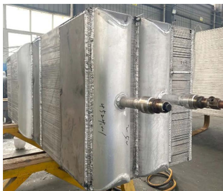
图2 高效正仲氢转化及换热一体化换热器正机
