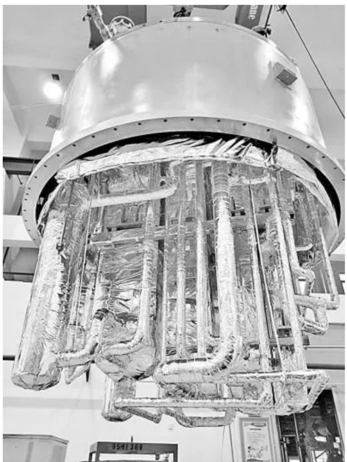
氮气液化器低温组件
