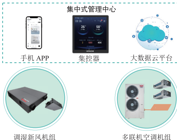
图2.2-14 全室内微气候环境智能高效调控的多联机和新风系统
