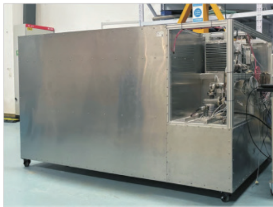
图2.5-38 -120℃空气制冷深冷冰箱原理机实物图
