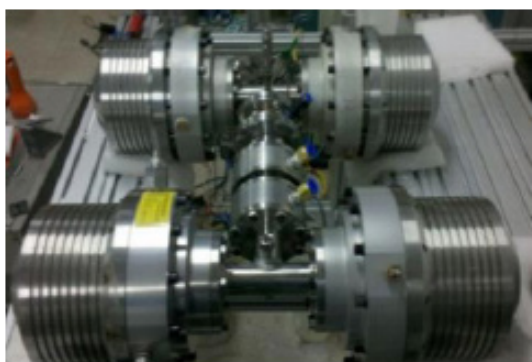
图2.5.1-2 电驱动自由活塞热声斯特林空气源热泵
