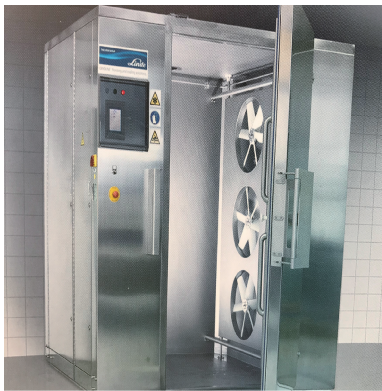
图 5 某柜式液氮速冻机
