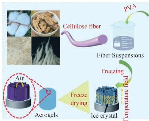
图4 天然纤维素气凝胶制备 [26]
