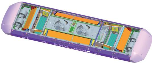
图1 地铁列车空调制冷系统
